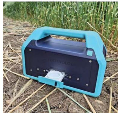
Die battery-aangedrewe PES-handtoestel verander grondtoetse in 'n proses wat vyf minute neem.
